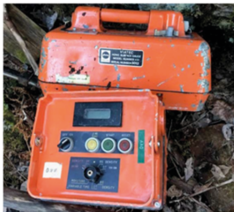
Figur 3: Gammel asfaltmåler med radioaktive kilder funnet i veikanten langs fylkesvei 503 ved Flatdal i Telemark. Foto: privat.
